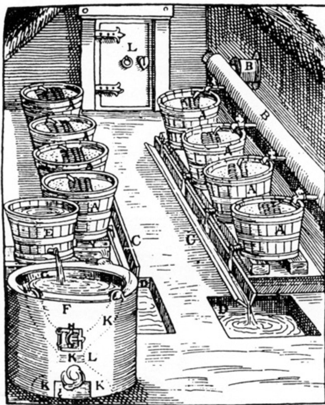
Figur 15. En mere arbejdsbesparende version med indlagt vand i udborede træstammer med vandhaner og ludtransport i træender. Vi ved, at Christian IV's syderi ved Kolding i begyndelsen af 1600-tallet var udstyret med en del tilsvarende træender. Herudover fandtes der her overskårne tønder, fade, øseskeer, indmurede kobberkar og skorsten. Billede fra Lazarus Ercker, ca. 1580 8,22,23 .
