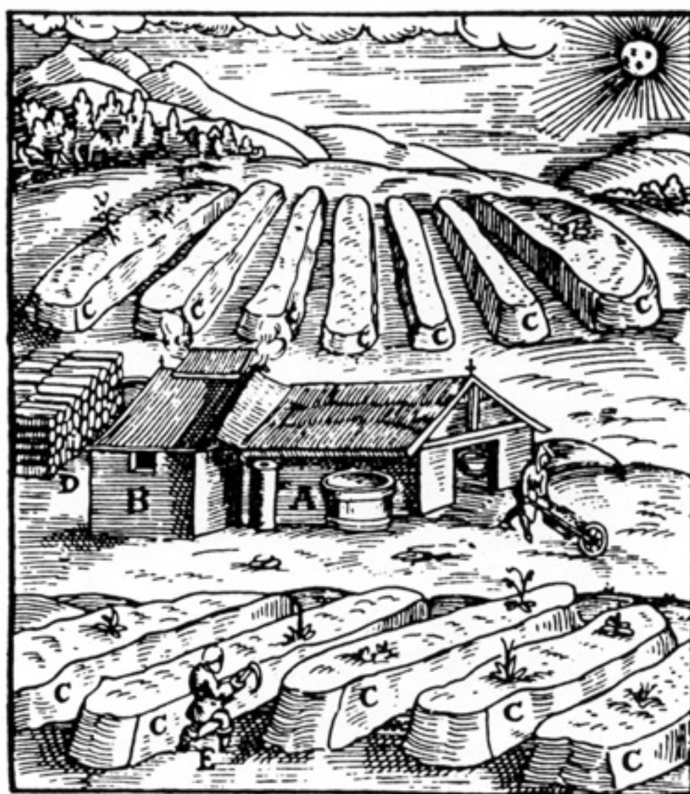
Figur 12. Salpeterjord anbragt i lange dynger, »bede«. Det er formentlig ikke korrekt, at jorden er anbragt under åben himmel. Givetvis har det været anbragt i laden til højre, mens sydningen sikkert er sket i sydehuset til venstre, med røg ved taget. Man ser tydeligvis en mand i færd med at afskrabe salpeterudblomstringer. Bemærk brændestabelen i bekvem nærhed af sydehuset. Den er sikkert underdimensioneret, idet der gik mange læs brænde til (100?) per tønne salpeter. Billedet er fra ca. 1580 (Lazarus Ercker's lærebog) 1,4,22 .
