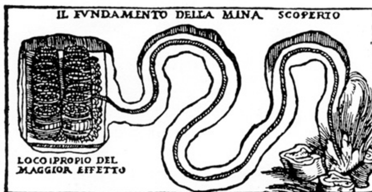
Figur 9B: Krudtets anvendelse til bortsprængning af hele fæstningsanlæg blev hurtigt benyttet. I 1495 skal spanierne således med krudt have sprængt sig ind i Napolis fæstning »Castel Nuovo« ved hjælp af en træafstivet minegang. Billedet fra Biringuccio's bog »De la Pirotechnia« fra 1540 1 og 18 .
